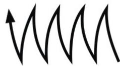
Применяют для стыковых швов со скосом кромок и для угловых швов с катетом менее 6 мм, выполняемых в любом положении электродами диаметром до 4 мм.
