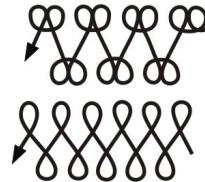
Используют для усиленного прогревания кромок шва, особенно при сварке высоколегированных сталей. Электрод задерживают на краях, чтобы не было прожога в центре шва или вытекания металла при сварке вертикальных швов.
