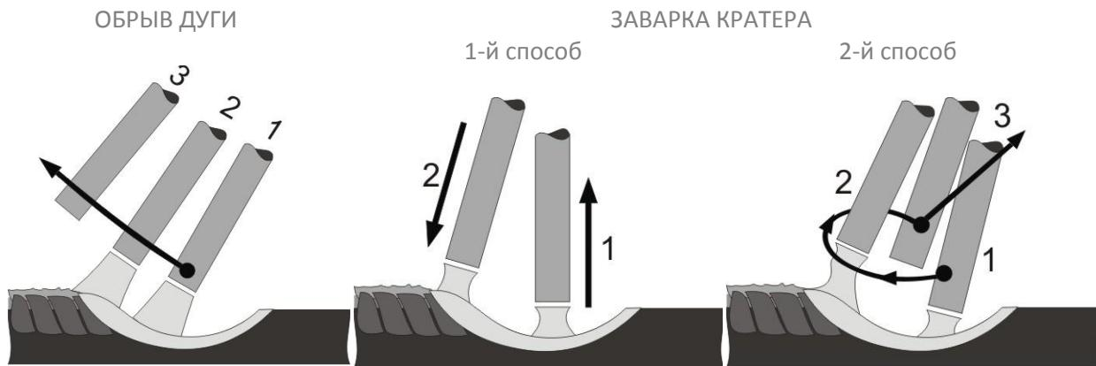
В конце шва нельзя обрывать дугу сразу. Электрод перемещают на край сварочной ванны (1,2) и затем быстро отводят (3) от кратера.
