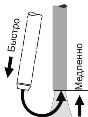
**Положения электрода при сварке**
