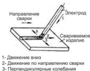
Рисунок 13.4 Три основных направления движения электрода
