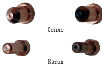
Рис. 7.6. Износ сопла и катода.
