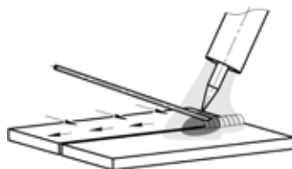
Рис. 8.6. Пример манипуляции присадочной проволокой при TIG сварке.
