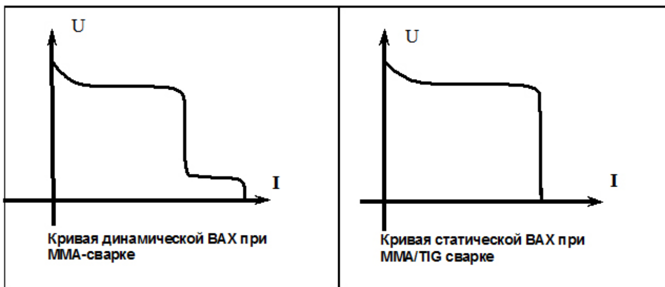
Рис 4.1 Кривая ВАХ аппарата
