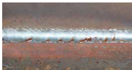
Рис 9.2. Сварной шов при максимальном значении индуктивности.
